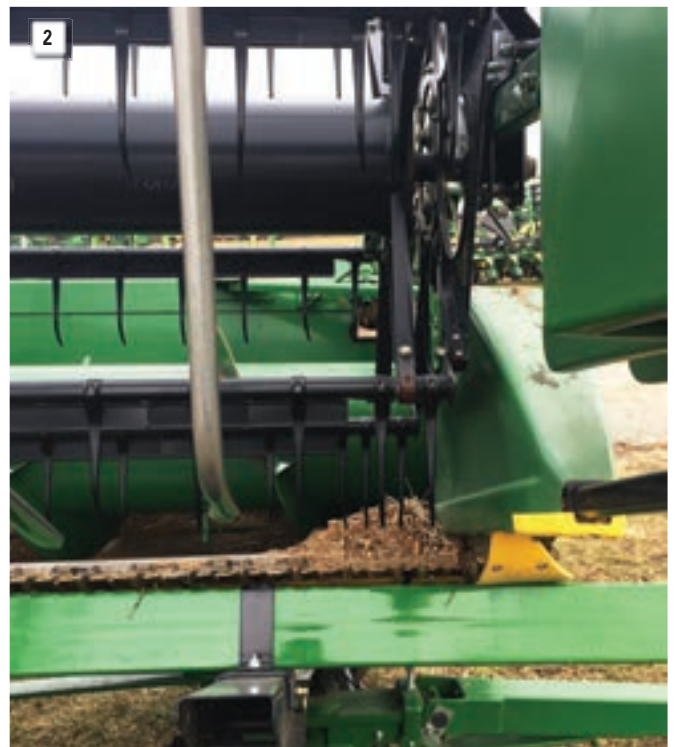
▼ 1: AWS gebruik 'n aluminium luggyp uit een stuk wat nie gelas is nie. ▲ 2: Die spuitstukke moet die hele lem skoonhou anders kan pakprobleme voorkom.
