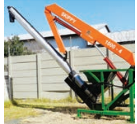
▲ Die awegaar-kraan-kombinasie waarmee een ton kunsmis-sakke gemaklik hanteer kan word en waarmee 'n planter maklik gevul kan word.
